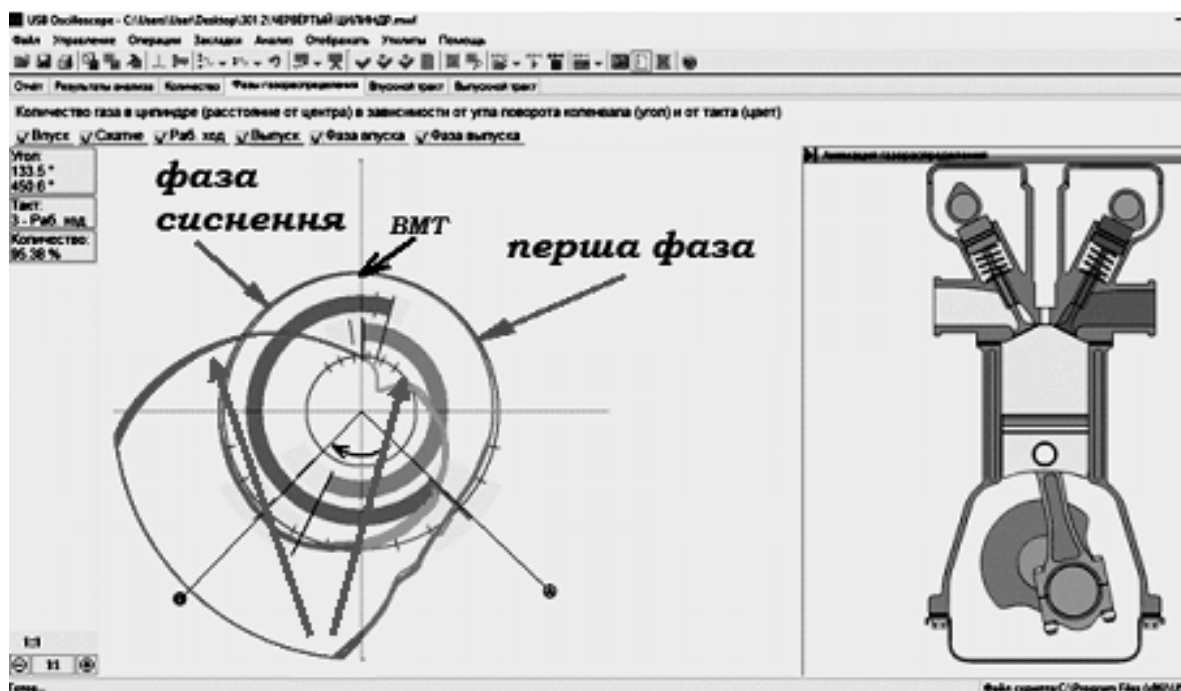
Рис. 1 Фази робочого циклу двигуна
