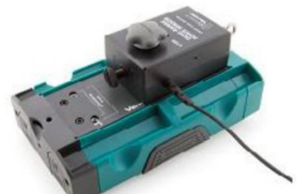
Рис. 1.12. Кріплення дводіпазонного датчика сили [81]
