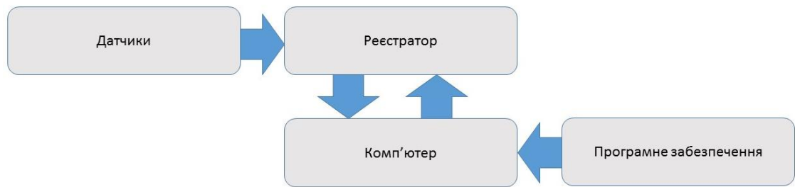
Рис. 1.15. Взаємозв'язок між компонентами цифрової лабораторії
