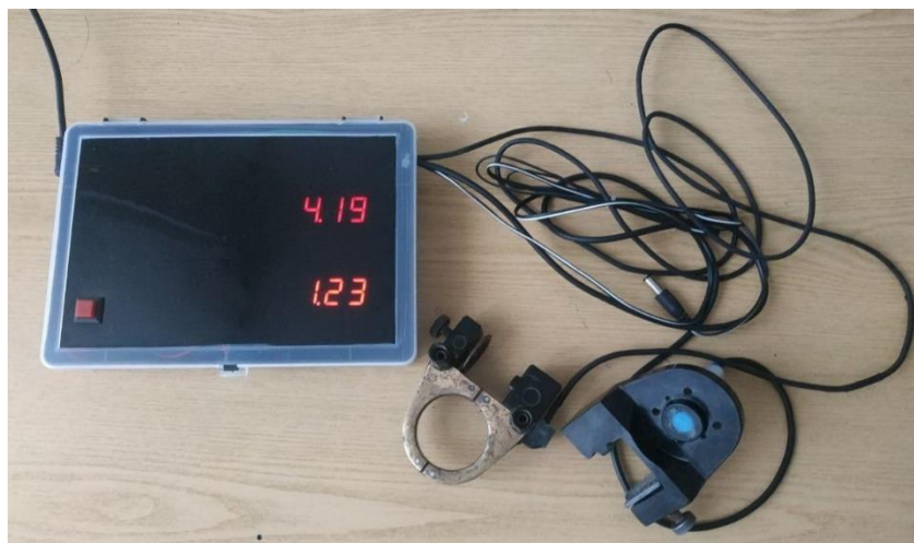
Рис. 2. Модернізований блок керування з датчиками установки Атвуда.
